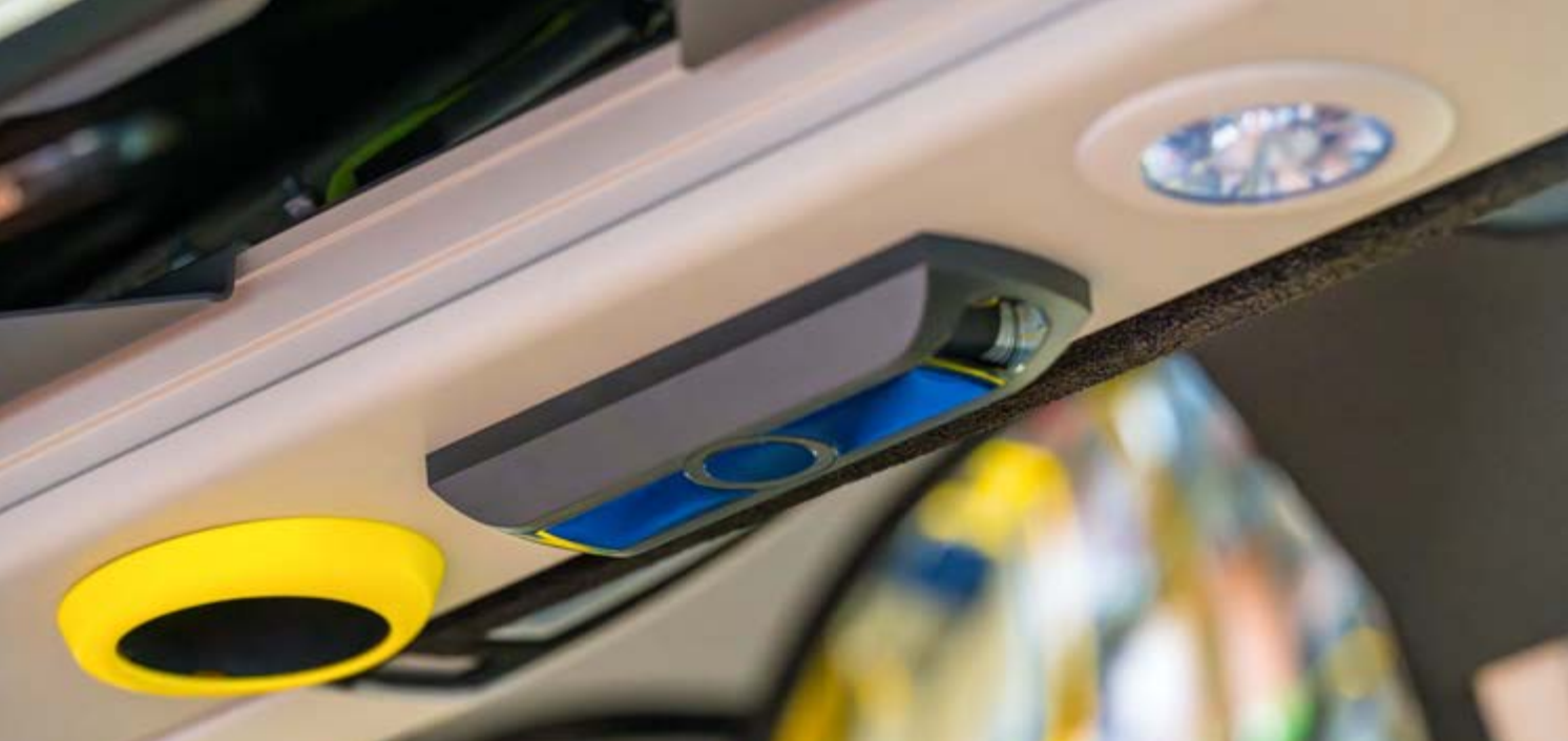
Eingebauter Sensor zur automatischen Fahrgastzählung in einem Linienbus.
